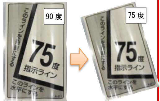
(写真) 角度指示ラベル
